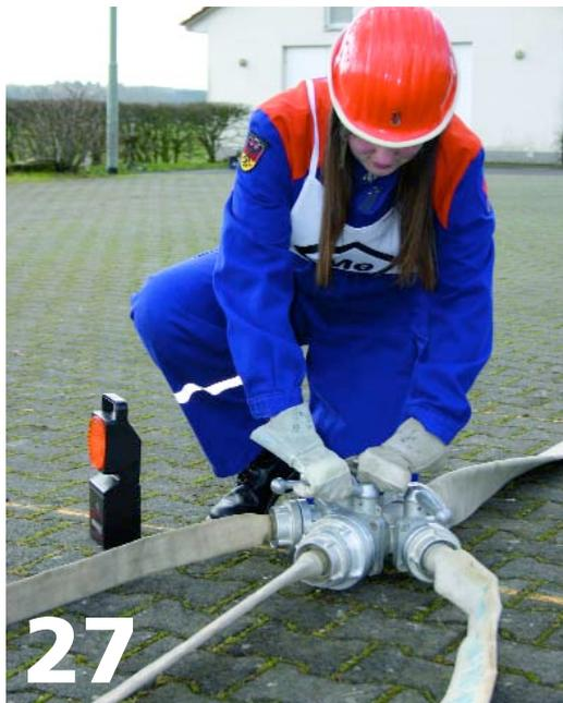
◀ Die Trupps geben nacheinander den Befehl: „1./ 2./ 3. Rohr Wasser halt!“. Der Melder reagiert auf diese Befehle entsprechend, schließt den Verteiler und kuppelt anschließend die Schläuche ab.
