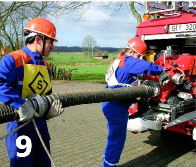
Der Maschinist kuppelt die Saugleitung an die Feuerlöschkreiselpumpe an, gibt das Kommando „Fertig!“ und schlägt gegebenenfalls die Halteleine an einen Festpunkt an.
