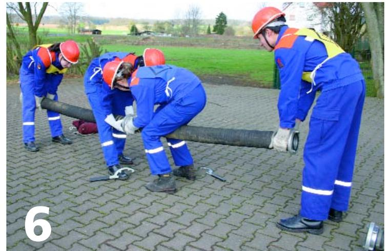
Wassertrupp und Schlauchtrupp koppeln wie gewohnt, d. h. Führer hinter Führer und Mann hinter Mann, die Saugleitung vom Saugkorb aus beginnend zusammen. Das eigentliche Kuppeln obliegt dem Wassertrupp. Die Unterstützung durch den Schlauchtrupp entfällt nur, wenn lediglich ein oder zwei Saugschläuche benötigt werden.
