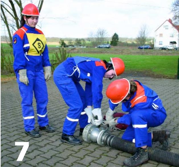
Beim Kuppeln selbst gibt es Unterschiede: Die Nieder-Bessinger führen die Saugschläuche in Kniehöhe zusammen und legen sie ab, um sie zu kuppeln. Das ist gerade für die jüngeren Mitglieder einfacher, als die Saugschläuche mit einer Hand zu halten.
