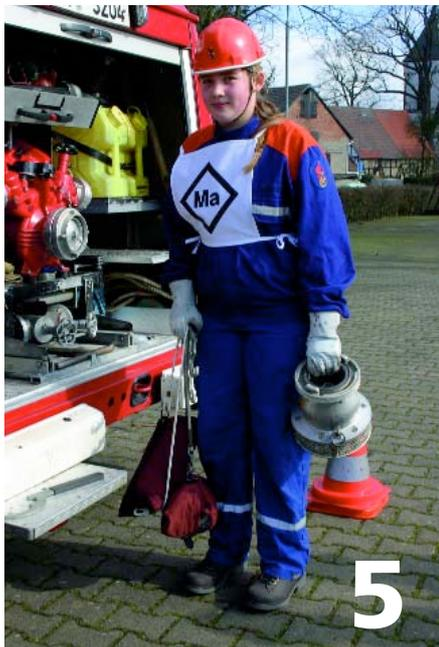
Der Maschinist legt die erforderlichen Kupplungsschlüssel, Saugkorb, Ventilleine und gegebenenfalls Halteleine an der Wasserentnahmestelle bereit.
